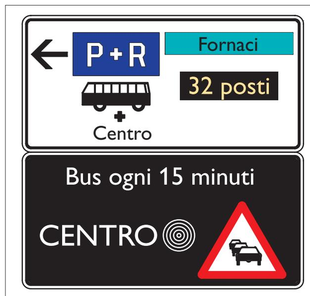
Fig. 3 – Esempio di pannello di accesso ai posteggi P+R
