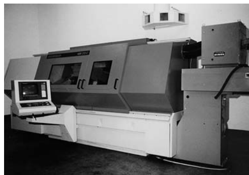
Macchina incapsulata provvista di aspiratore e filtro elettrostatico.
