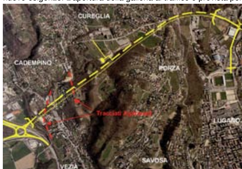
Fig. 31 – Tracciato della galleria Veduggio-Cassarate
