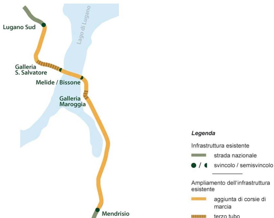
Figura 68: Schema di ristrutturazione della N2 secondo la variante 1-2 - Fonte USTRA
