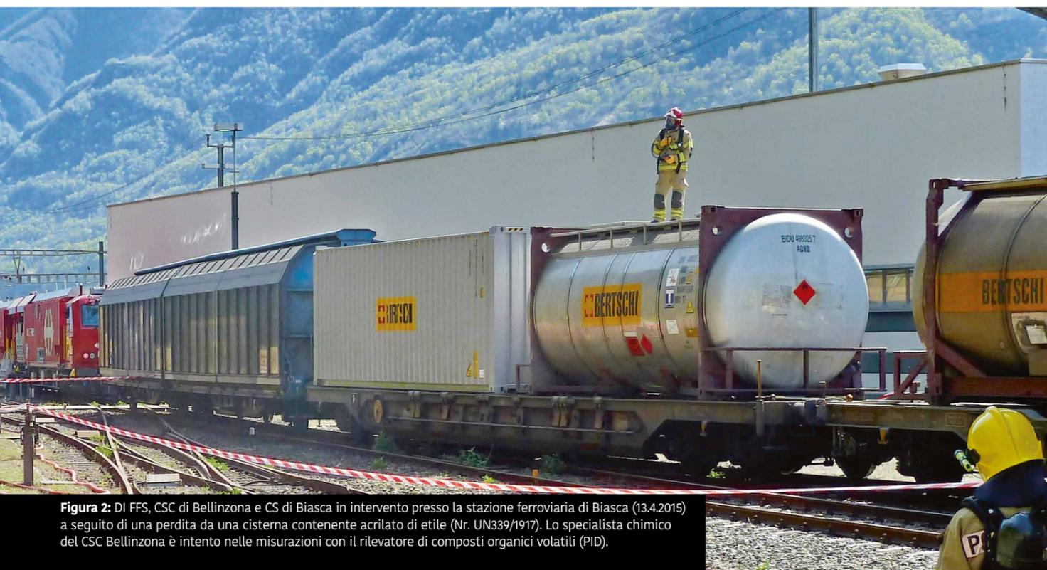
**Figura 2:** Di FFS, CSC di Bellinzona e CS di Biasca in intervento presso la stazione ferroviaria di Biasca (13.4.2015) a seguito di una perdita da una cisterna contenente acrilato di etile (Nr. UN339/1917). Lo specialista chimico del CSC Bellinzona è intento nelle misurazioni con il rilevatore di composti organici volatili (PID).
