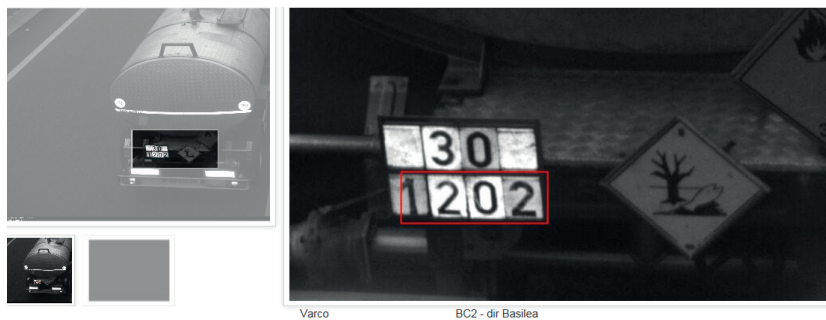
Figura 2: esempio di rilevamento del trasporto di merci pericolose – autobotte con liquido infiammabile in direzione nord (novembre 2016). Il numero ONU 1202 viene registrato per identificare il tipo di sostanza (nel caso specifico: carburante diesel o gasolio o olio da riscaldamento leggero).
