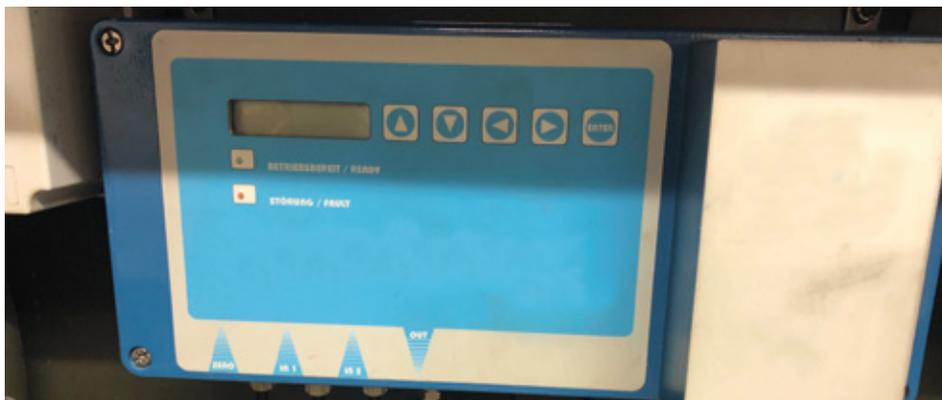
Analizzatore della concentrazione di PER all'interno della macchina
