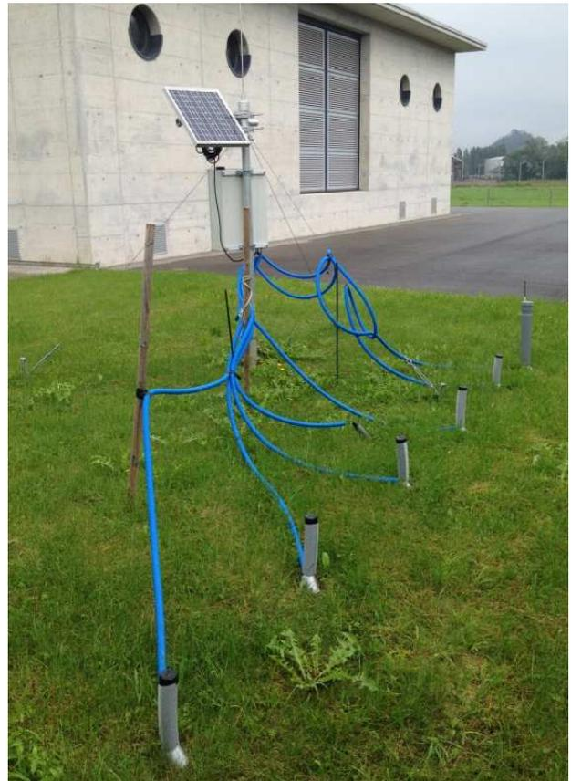
**Figura 1:** Stazione di misura a Stabio, composta di sei tensiometri collegati a un sistema centrale automatizzato per la raccolta dei dati.
