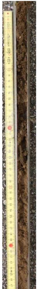
**Figura A1:** Campione prelevato con una trivella manuale
