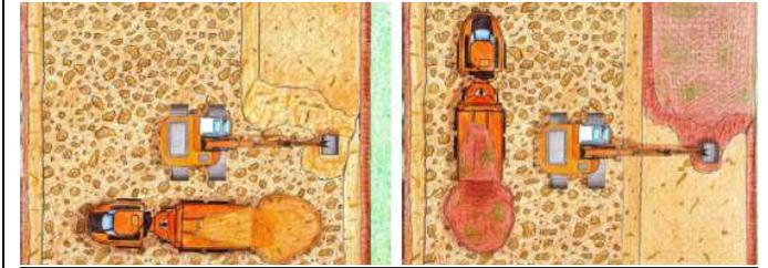
**Ripristino del suolo:** Un camion trasporta l'orizzonte B e l'escavatore cingolato lo posa. Un altro camion trasporta l'orizzonte A e l'escavatore lo posa sopra l'orizzonte B. Camion e escavatore transitano sull'orizzonte C. (Foto: " Suolo e cantieri. Stato della tecnica e della prassi – UFAM 2015).
