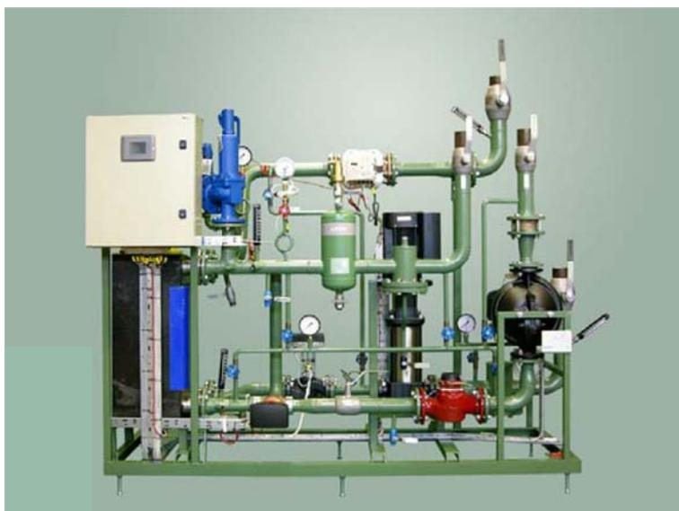
Figura 5-5: Sottostazione dedicata e predisposta al solar district heating (conteggio separato dei flussi entranti ed uscenti dall'utenza).
