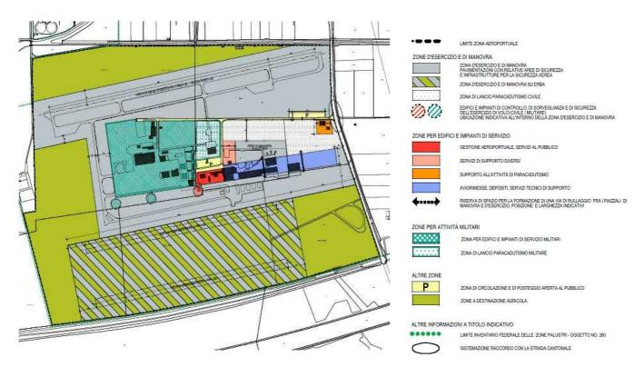
L'impostazione del progetto preliminare prevede che le destinazioni d'uso all'interno della struttura sono l'hangaraggio e la manutenzione di aeromobili per le strutture che si affacciano verso sud. I servizi logistici e operativi sono raggruppati in un corpo unico che si sviluppa su tre piani posizionato sul lato nord.
