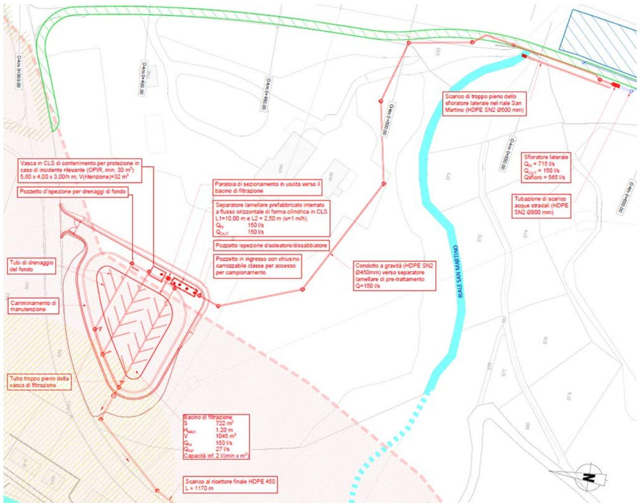
Il sistema esistente di trattamento delle acque stradali inquinate è considerato non a norma. Nell'ambito del progetto è dunque prevista la completa dismissione dei manufatti separatori e degli scarichi esistenti nell'ottica di realizzare un impianto di trattamento che permetta una depurazione delle acque adeguata.
