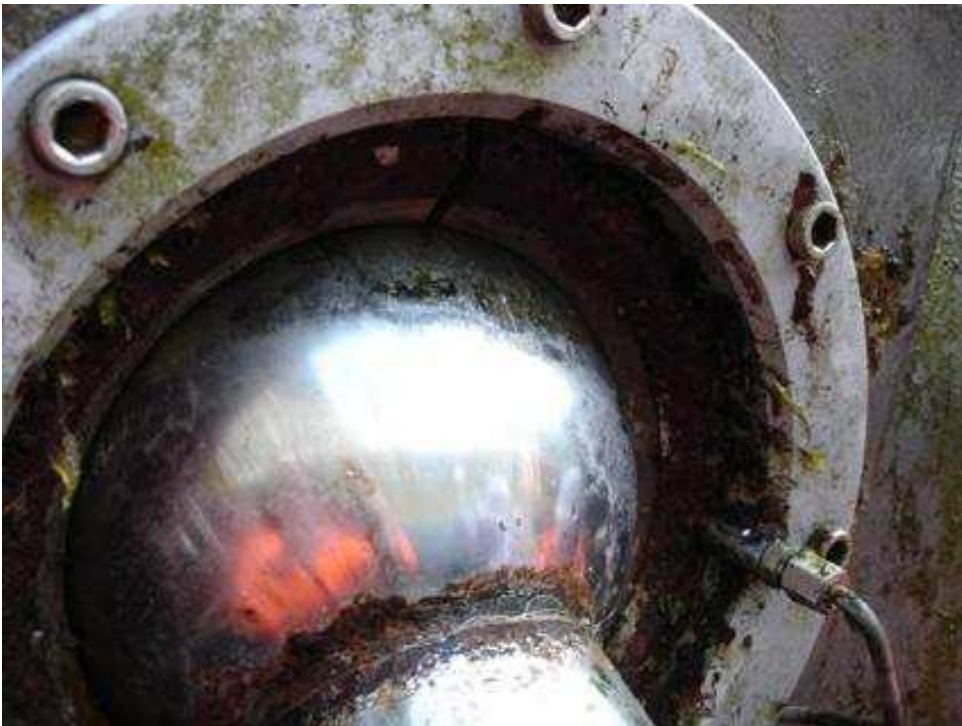
Foto 8: Cerniera sferica dell'asta oscillante con circuito grassaggio
