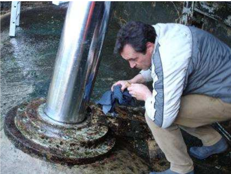
Foto 6: Pistone con frange di chiusura e anello raschiaolio
