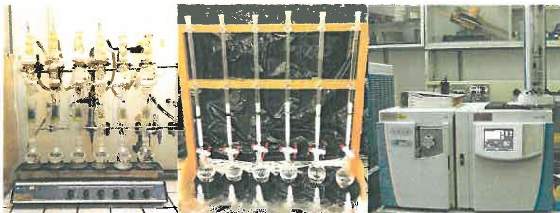
Figure 6: Extraction avec Soxhlet, purification et analyse GC-MS
