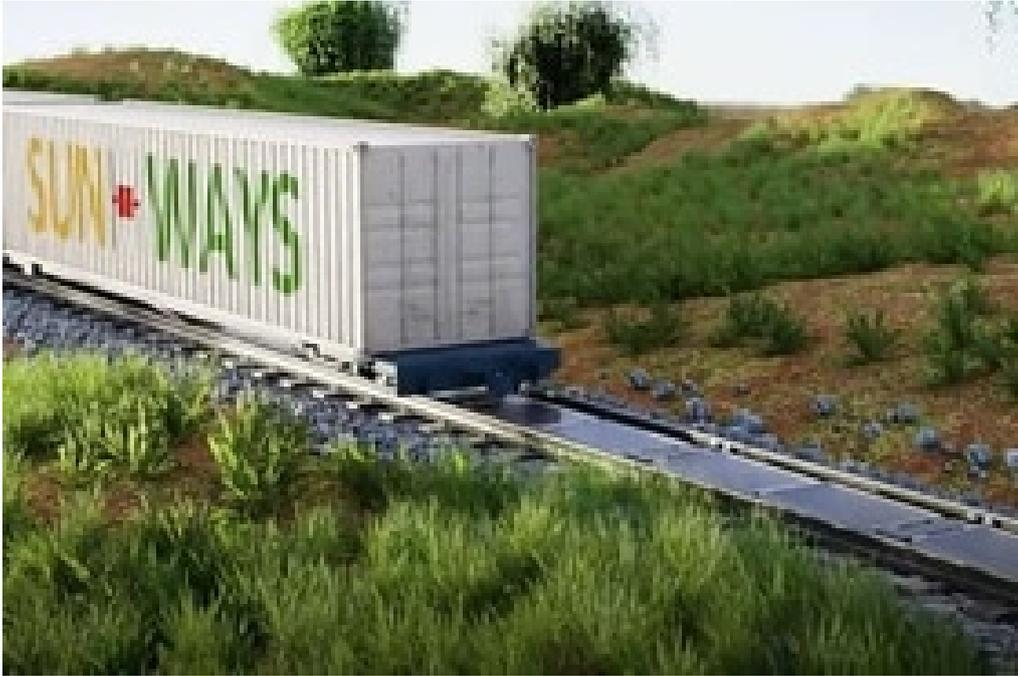
L'aspetto innovativo del progetto, sviluppato in collaborazione con il Politecnico di Losanna, sta nella *facilità di rimozione dei moduli, caratteristica necessaria per semplificare le operazioni di manutenzione ordinaria e straordinaria che coinvolgono normalmente le linee. Il sistema fotovoltaico preassemblato infatti è in grado di essere dispiegato sull'infrastruttura ferroviaria con facilità e in sicurezza.*<sup>3</sup>
