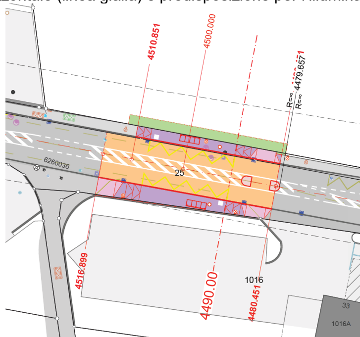
Adegumento della fermata bus e nuovo attraversamento pedonale presso la fermata Stabio Case Rapelli
