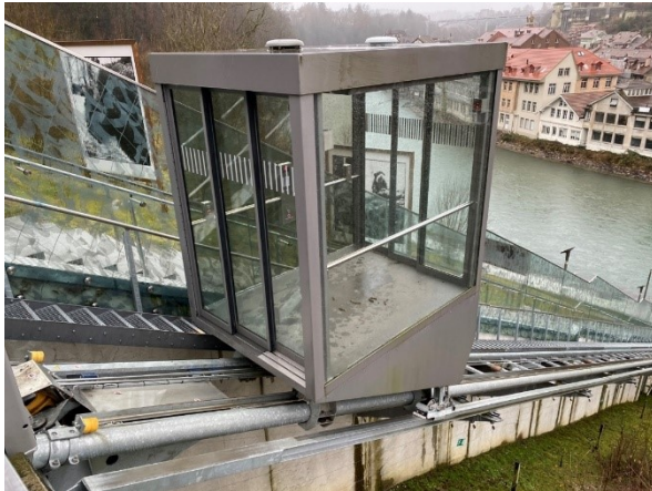
Esempio di cabina con sbarco frontale e vetri panoramici (Bärenpark, Berna)
