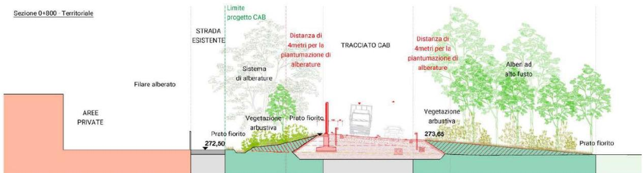
Figura 29: Sezione tipologica tratta in rilevato
