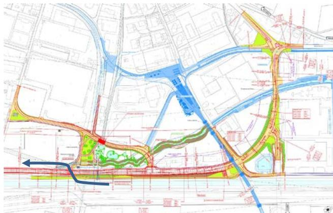
Figura 73: Estratto planimetrico ubicazione scarico del sovraccarico trecentenarie del Vedeggio (freccia blu)
