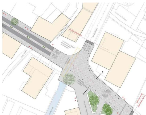
Figura 63: Intervento a Bioggio, rimozione sottopassaggio
